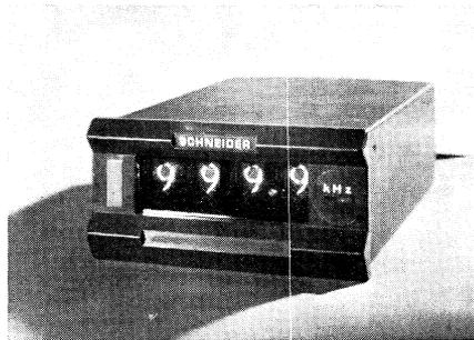
La base de temps est obtenue à partir du réseau 50 ou 60 Hz. La durée de l'affichage sur 4 tubes décimaux est ajustable entre 0,1 s et 10 s afin d'adopter la lecture au temps d'ouverture de porte choisi (0,01 — 0,1 — 0,6 ou 1 s). La sensibilité, réglable, est meilleure que 50 mV <sub>eff</sub>.
