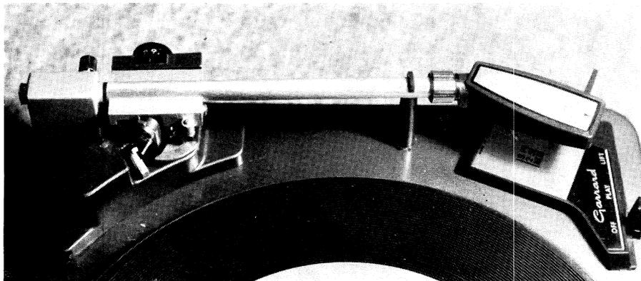
Le bras de lecture, du type court, permet la compensation de l'erreur de piste grâce à l'angle existant entre les plans contenant la section rectiligne et l'embout amovible.
