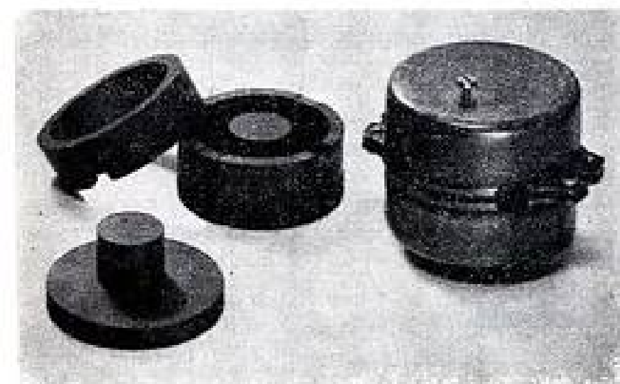
FIG. 2. — Pot double utilisé en basses fréquences.
