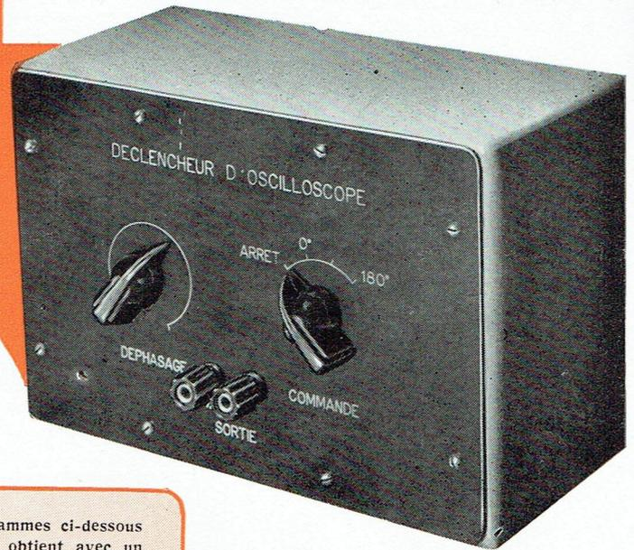
L'observation visuelle, au moyen d'un oscilloscope, d'un phénomène récurrent à la fréquence du réseau, se rencontre fréquemment dans l'industrie, qu'il s'agisse de détecter l'ionisation et les effluves apparaissant dans un isolant fatigué, au voisinage de chaque maximum de la tension appliquée (fig. 1), de contrôler le fonctionnement de thyristors pour la commande de moteurs ou de machines à souder (fig. 2), de voir la forme d'onde déli-
