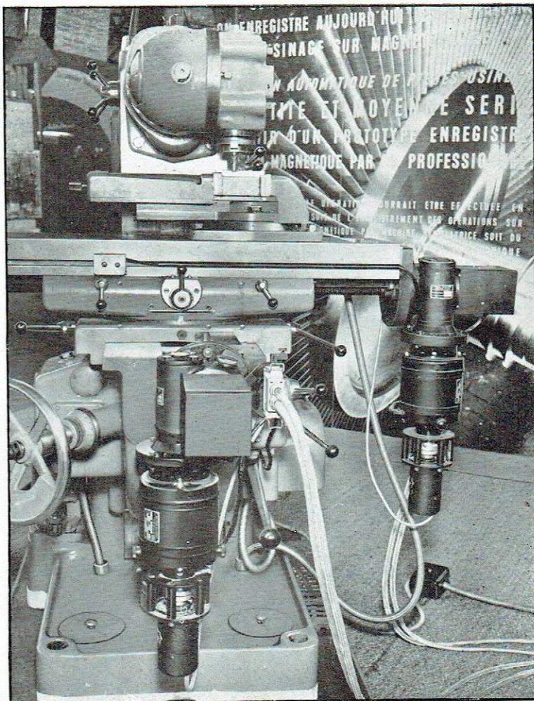
de l'un des trois moteurs asservis : celui accouplé à la visière de la fraiseuse et ceux commandant les déplacements de l'outil dans les deux autres axes de coordonnées.
