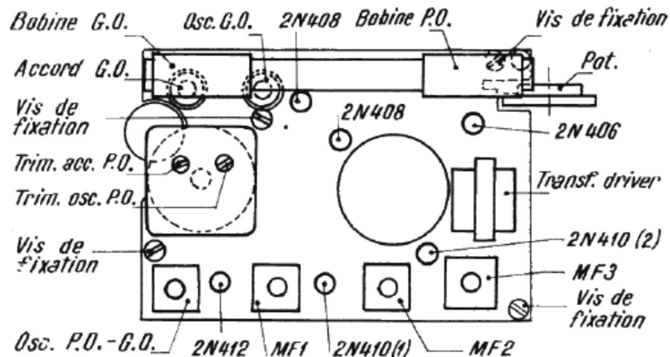
Emplacement des éléments et des différents ajustables sur le châssis du récepteur « Translitor Pocket ».
