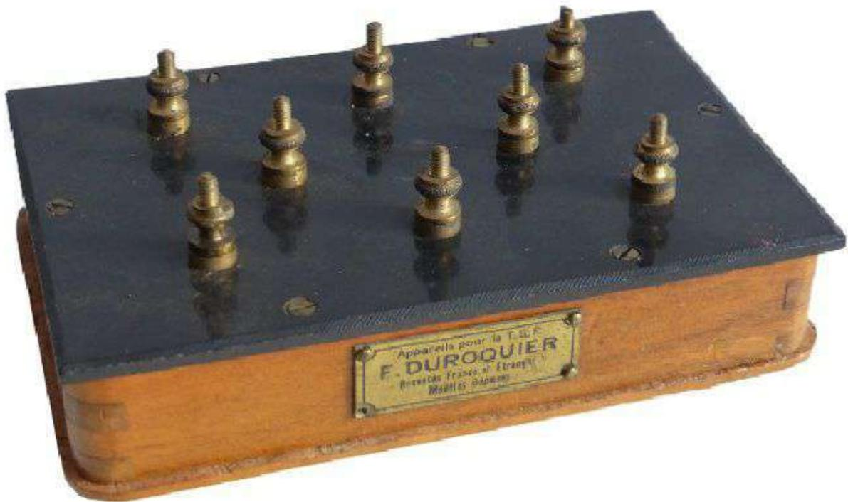
FIG. 129. — Table de résistances et condensateurs de liaison Duroquier.
