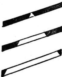
Fig. 97. — Les trois lignes analysées dans l'image placée en haut sont, à la sortie de la détectrice, traduites par des tensions A, B et C représentées en haut. Après passage à travers un condensateur, ces tensions sont décalées comme il est montré en bas. Et si l'on ne prend pas de précautions appropriées, on verra sur l'écran du récepteur l'image représentée en bas.
