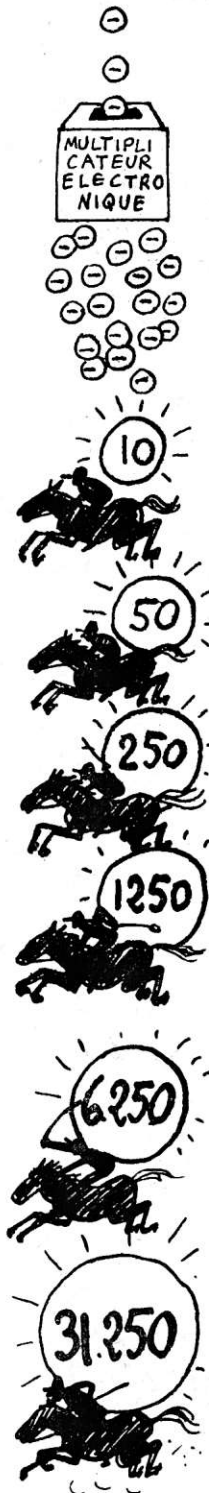
Fig. 68. — Schéma d'un multiplicateur électronique comportant cinq anodes soumises à des potentiels croissants.
