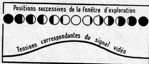
Fig. 4. — Formation d'une alternance du signal vidéo pour plusieurs phases successives de l'exploration de l'image.
