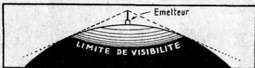
Fig. 1. — La portée sûre d'un émetteur à ondes métriques est limitée à son horizon visible.
