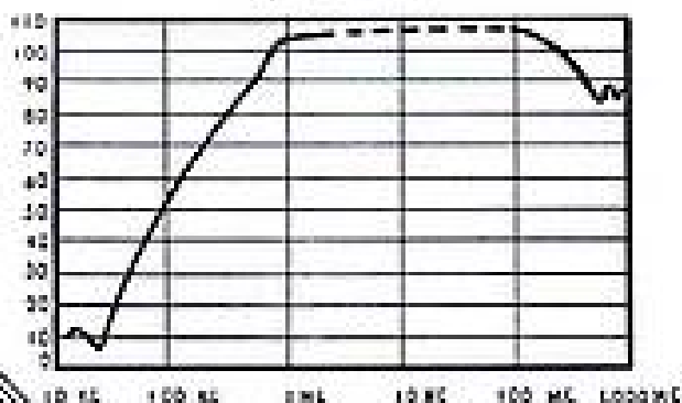
Courbe d'affaiblissement du filtre bifilaire, type 146 - 250 v. 30 ampères 400 périodes.
