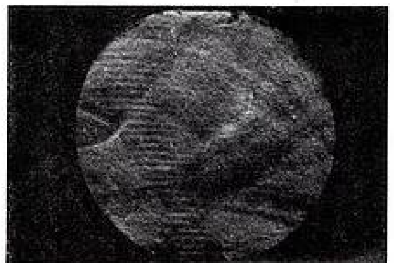
FIG. 13. — Déviation des faisceaux ultrasonores par un écoulement gazeux se propageant de droite à gauche.
