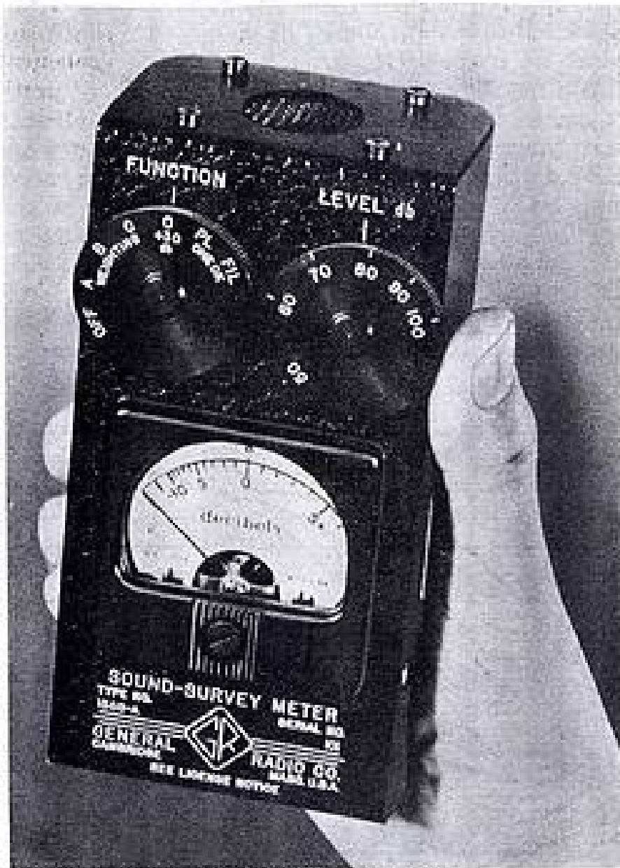
FIG. 6. — Appareil de mesure de bruits de poche. Constructeur : General Radio.
