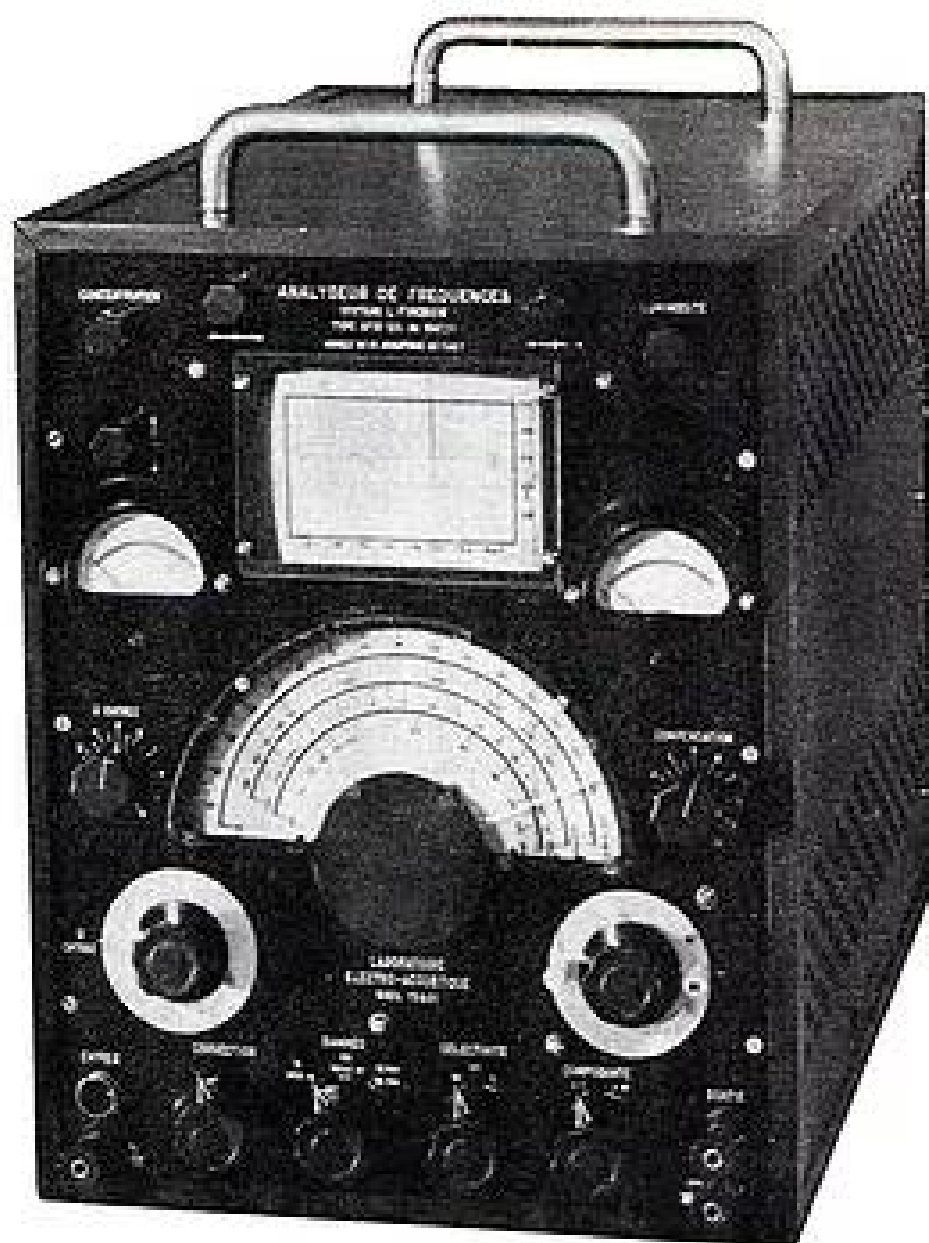
FIG. 13. — Analyseur basé sur le principe de la fréquence chercheuse avec enregistrement oscillographique.
