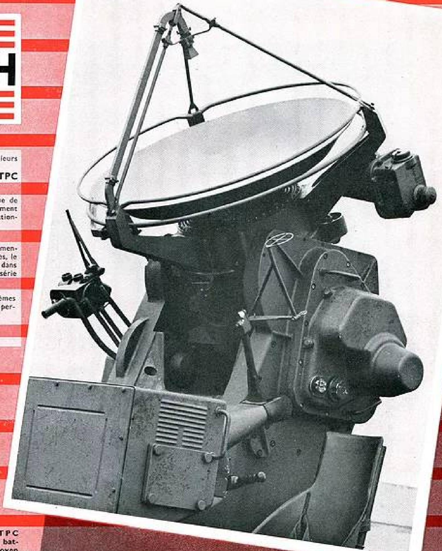
Télépointeur-Calculateur TPC pour la conduite de tir de batteries anti-aériennes de moyen calibre.
