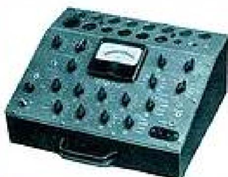
Vérifications et mesures sur les tubes de réception américains et européens. Relevé des caractéristiques dans des conditions analogues à celles d'emploi. Contrôle du filament, des courts-circuits et de l'isolement cathode. Mesure du débit anodique, de la pente, résistance interne, coefficient d'amplification. Relais de sécurité et fusible protégeant l'appareil contre les fausses manœuvres.
