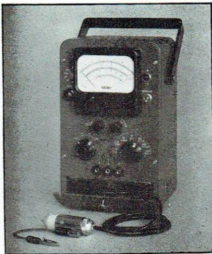
Voltmètre électronique modèle 743 de Métrix.
