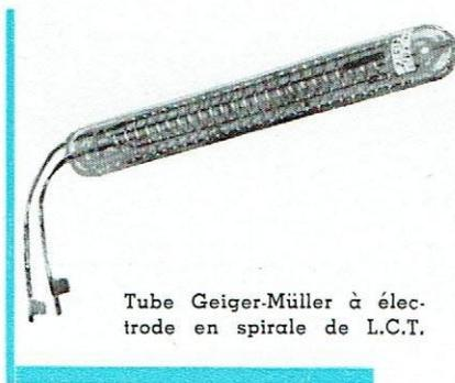
Tube Geiger-Müller à électrode en spirale de L.C.T.
