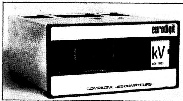
Indicateur numérique de tableau « Eurodigit », existe en voltmètre, ampèremètre, ohmmètre, fréquencemètre, etc. Capacité de lecture : 1500 points et 20 % de dépassement. Précision : 0,1 à 0,2 %  $\pm 1$  digit, suivant calibre (en continu); 0,5 % digit (en alternatif). Dimensions : 72 x 144 mm. Profondeur : 150 mm.
