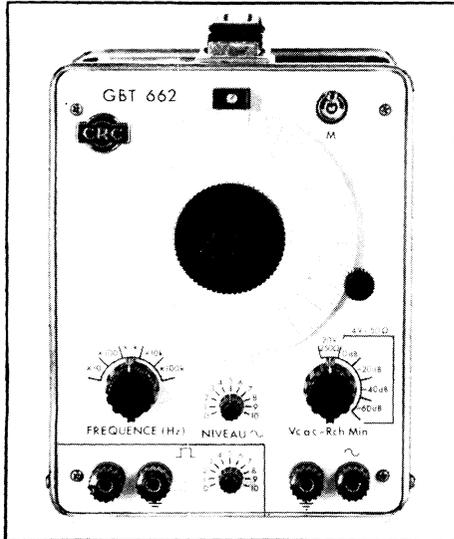
Générateur B.F. type GBT 662, transistorisé, délivrant des signaux sinusoïdaux ou rectangulaires et couvrant la plage de 10 Hz à 1 MHz en 5 gammes. Précision en fréquence :  $\pm 3\%$  de 10 Hz à 1 MHz. Stabilité : dérive à 1 kHz inférieure à  $10^{-4}$  pour  $\pm 10\%$  de variation du secteur. Sortie : 20 V c. à c. sur 250  $\Omega$  ou 4 V c. à c. sur 50  $\Omega$  (en sinusoïdal); 1,2 V sur 50  $\Omega$  (en rectangulaire). Alimentation secteur (CRC).
