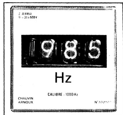
Fréquencemètres et tachymètres numériques. Affichage par 3 chiffres significatifs et un néon bâton formant 4<sup>e</sup> chiffre. La définition est de 1999 points. La fréquence, convertie en tension proportionnelle, est affichée directement. Pour les tachymètres, le signal d'entrée est fourni par un capteur magnétique ou une génératrice tachymétrique.
