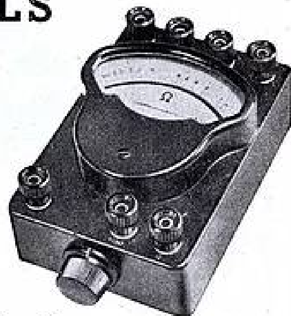
OHMMÈTRE 499 5 sensibilités de 1 Ω à 30 MΩ
