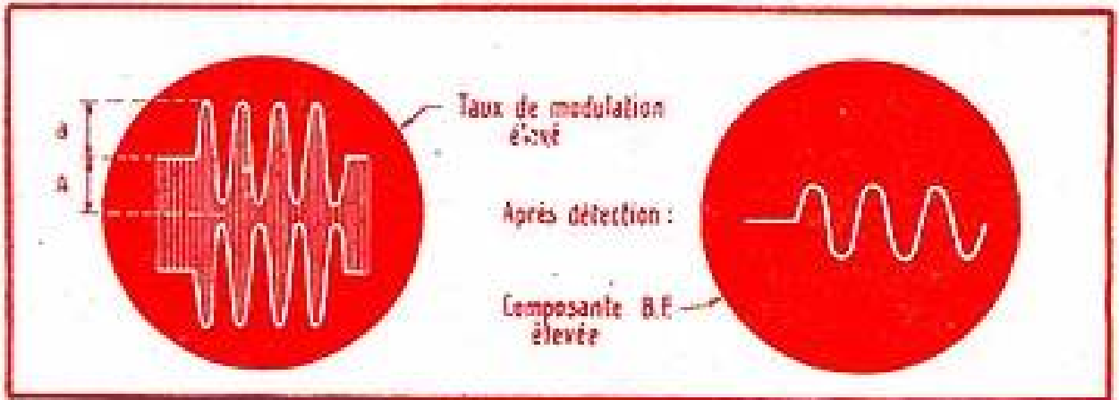
Fig. 15. — Lorsque le taux de modulation est élevé, la composante B.F., après détection, est également élevée.
