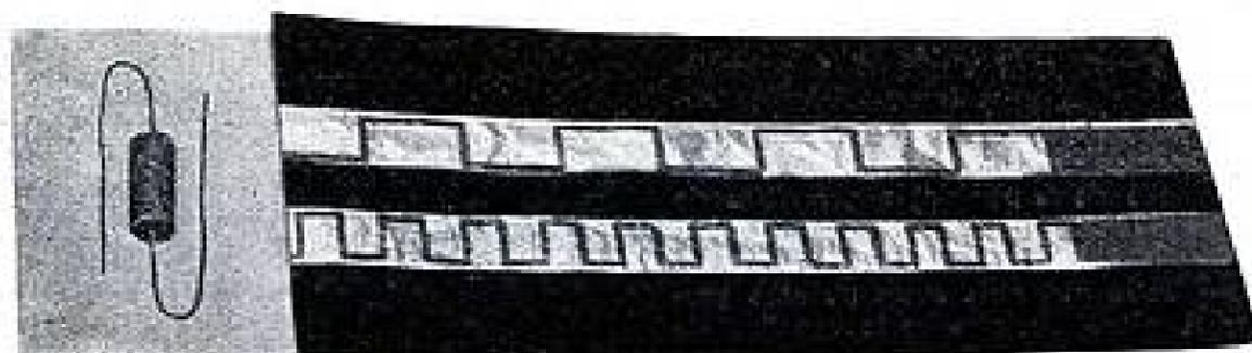
Un condensateur TEMCO de 40 000 pF, 150 V, type W 99. Diamètre : 6 mm ; longueur : 14 mm. Un autre condensateur identique a été déroulé. On voit ici les deux extrémités de la bande. La variation de largeur des dents est bien visible. Le condensateur complet comporte 170 de ces dents.
