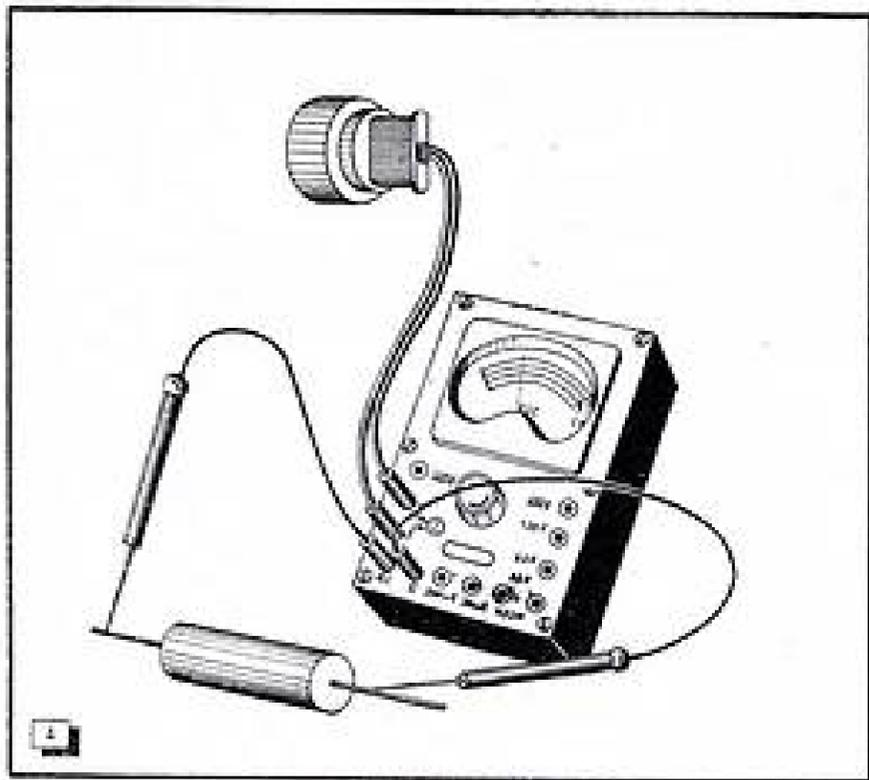
doivent être reliées au réseau au moyen d'un cordon. On court-circuitera ensuite à l'aide d'une connexion provisoire les douilles « O » et « RC » et on tournera le bouton de tarage central, de façon à amener l'aiguille exactement sur la graduation 0 à droite de l'échelle des ohms.
