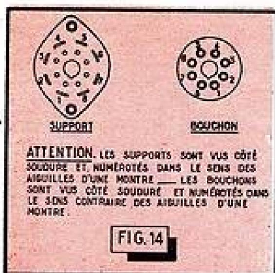
Représentation des supports et bouchons sur les différents plans de câblage.
