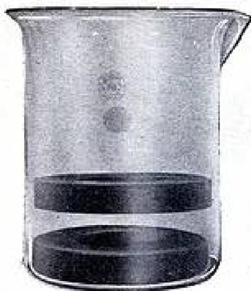
La répulsion magnétique explique pourquoi ce disque de Ferroxdure flotte en l'air.
