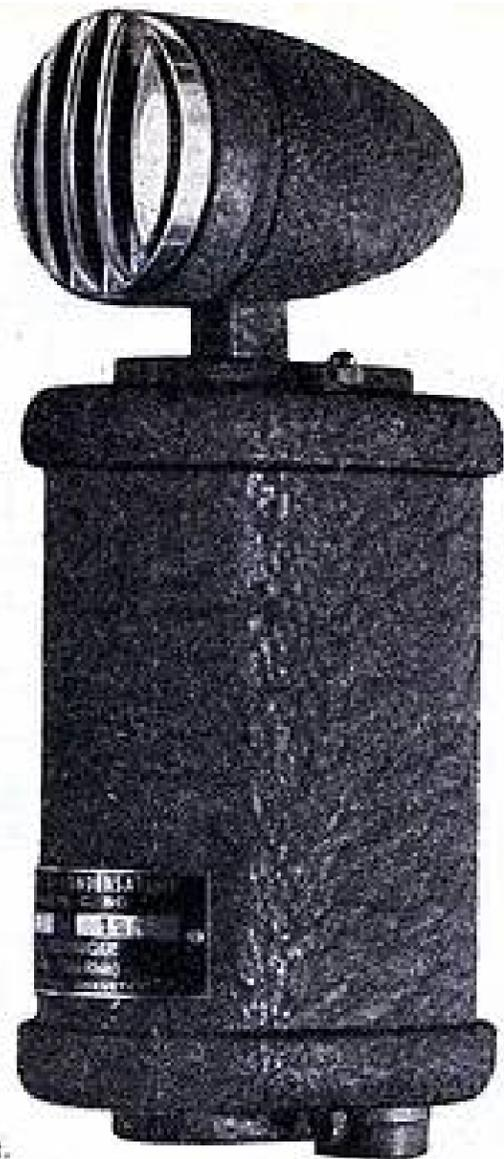
On voit ici l'aspect extérieur du microphone électrostatique M.C.50 monté sur le socle contenant le préamplificateur. La capsule microphonique est constituée par une armature métallique très mince formant membrane, en regard d'une autre armature métallique rigide. La capacité de ce condensateur se situe aux environs de 125 pF.
