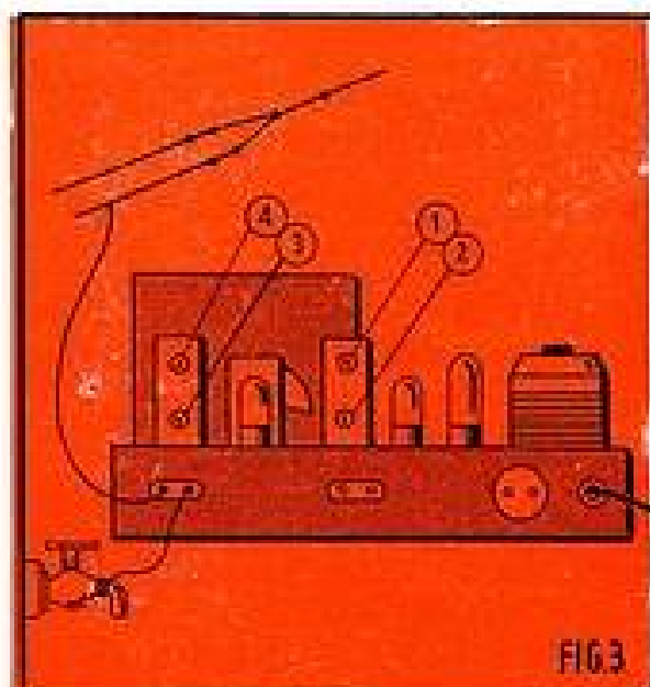
Fig. 3. — Lorsque on n'a pas d'hétérodyne, on peut opérer un réglage M.F. rudimentaire sur une émission P.O. Les chiffres indiquent l'ordre dans lequel les noyaux doivent être réglés.
