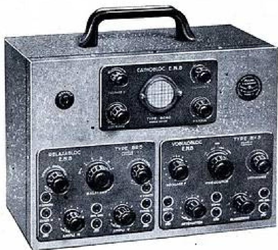
Aspect extérieur de l'appareil complet après montage des trois blocs dans le coffret
