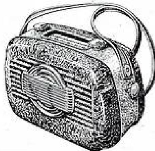
Comporte 6 lampes : 1T4, 1R3, 1T4, 1S5, 3Q4 et 117Z3. Grande sensibilité par étage amplificateur haute fréquence apériodique précédant le changement de fréquence — réception sur antenne incorporée dans la bandoulière — 3 gammes d'ondes — haut-parleur AUDAN 12 cm à grande sensibilité par membrane rhodoïd, spécial pour postes batteries — haute tension par pile 90 V et chauffage par pile 9 V — Fonctionne également sur secteurs tous courants 115 V et 220 V par commutation immédiate.
