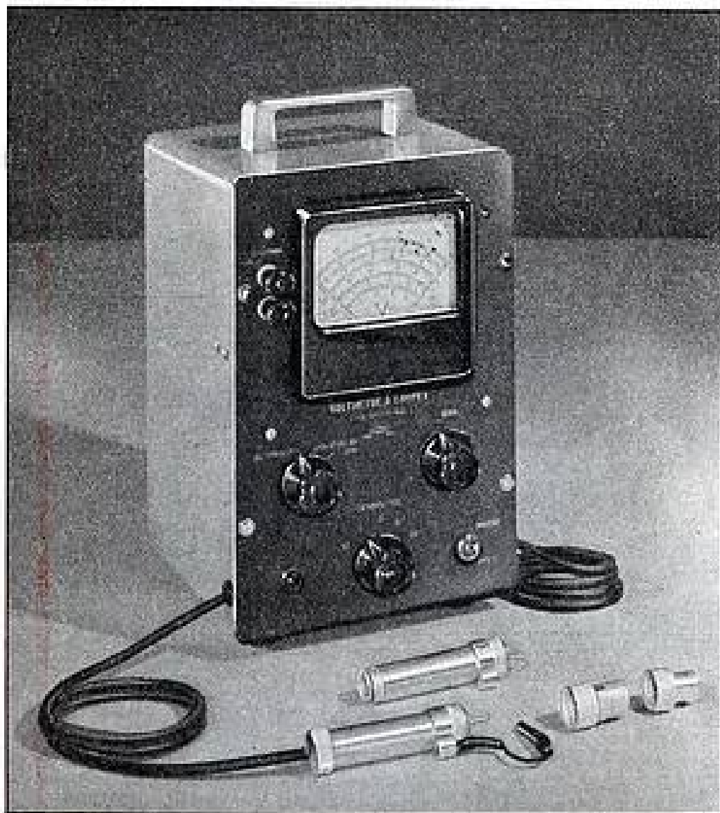
Un bel appareil de laboratoire : le Voltmètre à Lampes type A 201 (Périsol).
