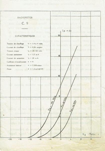
Cette lampe fait partie de nos nouvelles séries montées avec notre filament spécial à oxydes remarquable par sa grande régularité et sa longue durée.
