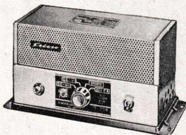
Vue de l'amplificateur G 223 et, à côté, de l'alimentation G 224. Sur cette dernière, on remarque l'interrupteur général, le commutateur accumulateur-secteur c.a. et la lampe-témoin. Sur l'ampli, de gauche à droite: entrées pour micro, contrôles de volume pour micro et P.U., entrées pour P.U. ou enregistreur ou syntonisateur (avec commutateur d'insertion), contrôle de tonalité, lampe-témoin et interrupteur général.
