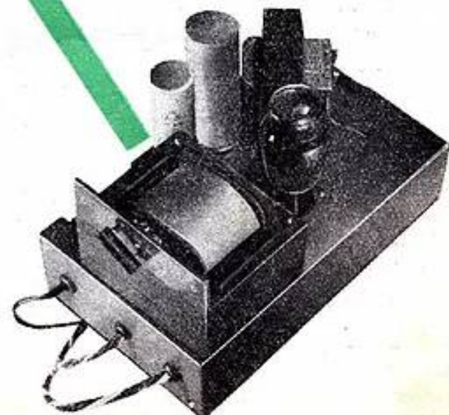
Châssis A. 75. Bloc alimentation donnant 75 mA.
