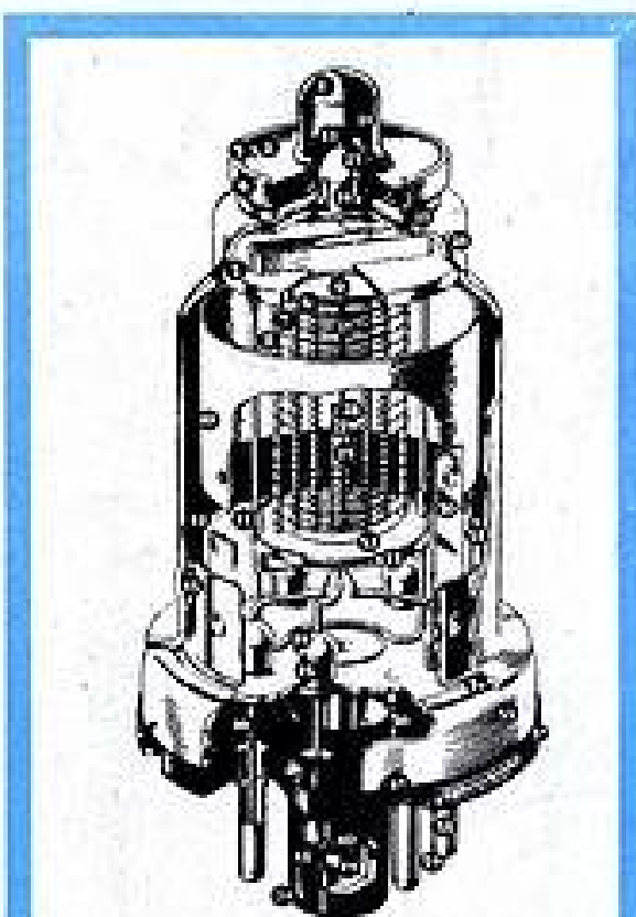
Fig. 2. — Montage d'un tube « tout métal » américain (tube 6J7 R.C.A.).
