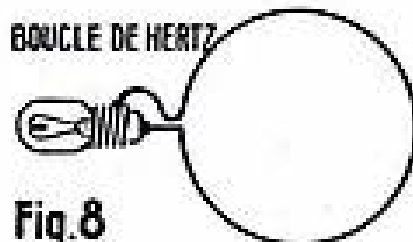
Fig. 8 — Boucle de Hertz utilisant une ampoule 3,5 V ; 0,2 A.
