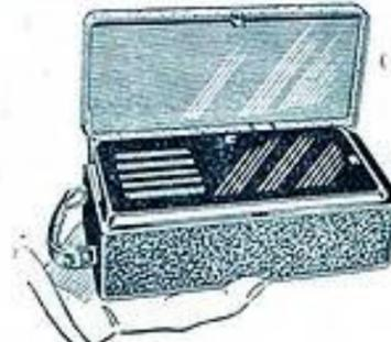
LA RÉALISATION D'UN POSTE BATTERIE PORTATIF. — Récepteur équipé avec des lampes subminiatures. Dimensions : 24x11x8 cm. 5. Description complète dans Radio-Plans d'août.
