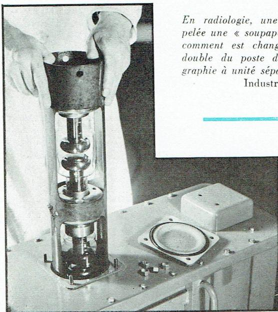
*En radiologie, une valve est appelée une « soupape ». On voit ici comment est changée la soupape double du poste de radiométallographie à unité séparée de Philips-Industrie.*
