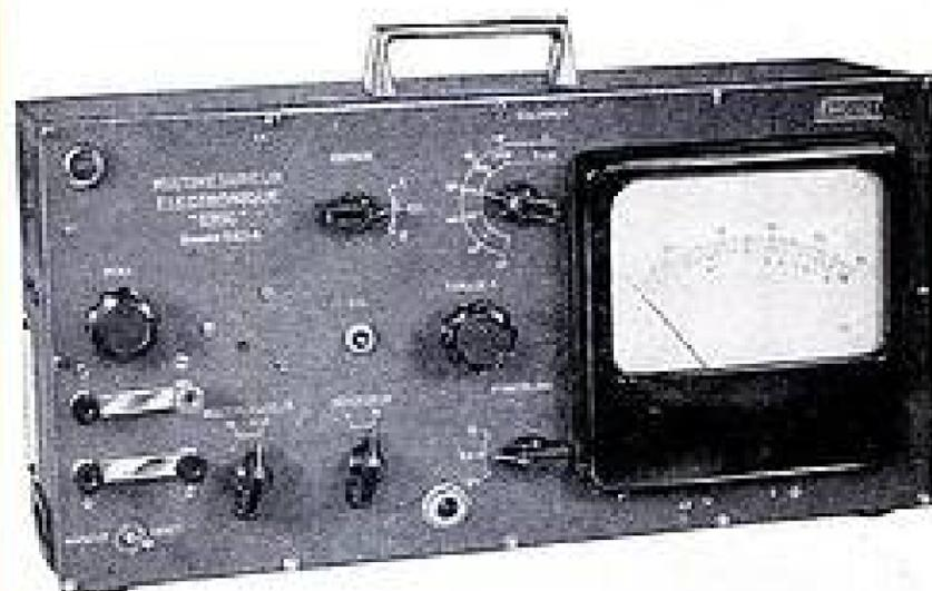
Le **MULTIMESUREUR UNIVERSEL** mesure : tensions faibles intensités, résistances, capacités, perte de charge, faibles variations de tension, Isolements pH, RH. Opère des intégrations.
