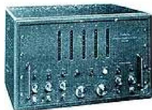
**LE BERKELEY COMPTEUR UNIVERSEL ET CHRONOMÈTRE**, instrument à fins multiples, fournit une lecture directe du temps écoulé avec une précision de  $\pm 1$  microseconde, mesure de fréquence jusqu'à 1 mégacycle avec précision de  $\pm 1$  cycle, période de mesure à partir de 0 cycle et au dessus avec précision de  $\pm 1$  microseconde et comptant jusqu'à 1 mégacycle. Modèle 5510.
