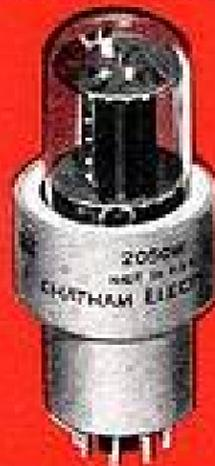
**5949/1907** — Thyatron à réservoir d'hydrogène. Polarisation nulle pour génération d'impulsion d'une puissance de crête jusqu'à 6,25 méga-watts.
