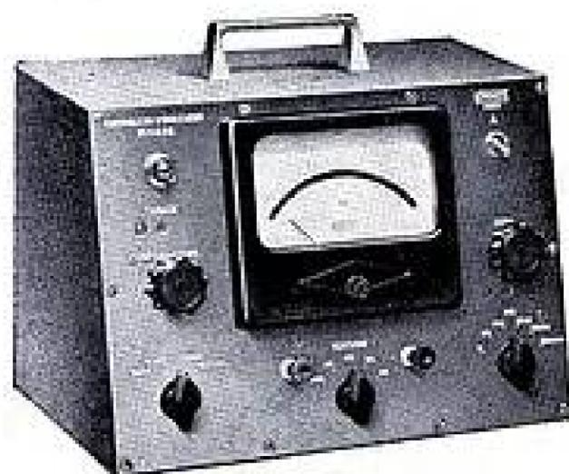
L'**ISO. R. METRE** permet la mesure de résistances même à caractère « capacitif » depuis  $10^9$  à  $10^{15}$ . Mesure également le Pico-ampère.
