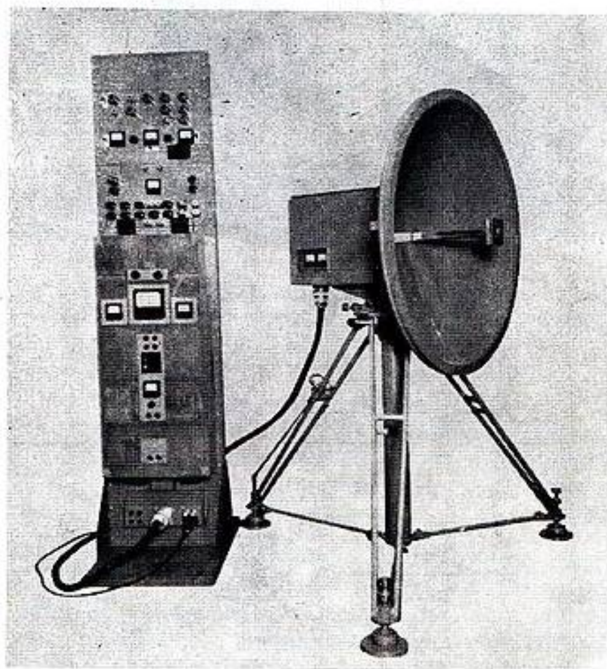
FIG. 1. — Emetteur expérimental pour faisceau hertzien à double modulation de fréquence.
