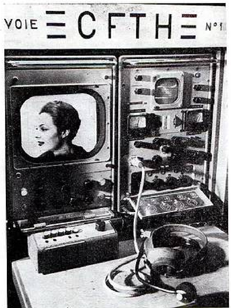
FIG. 4. — Salle des équipements. — Récepteur video de contrôle agem. Contrôle de voie.
