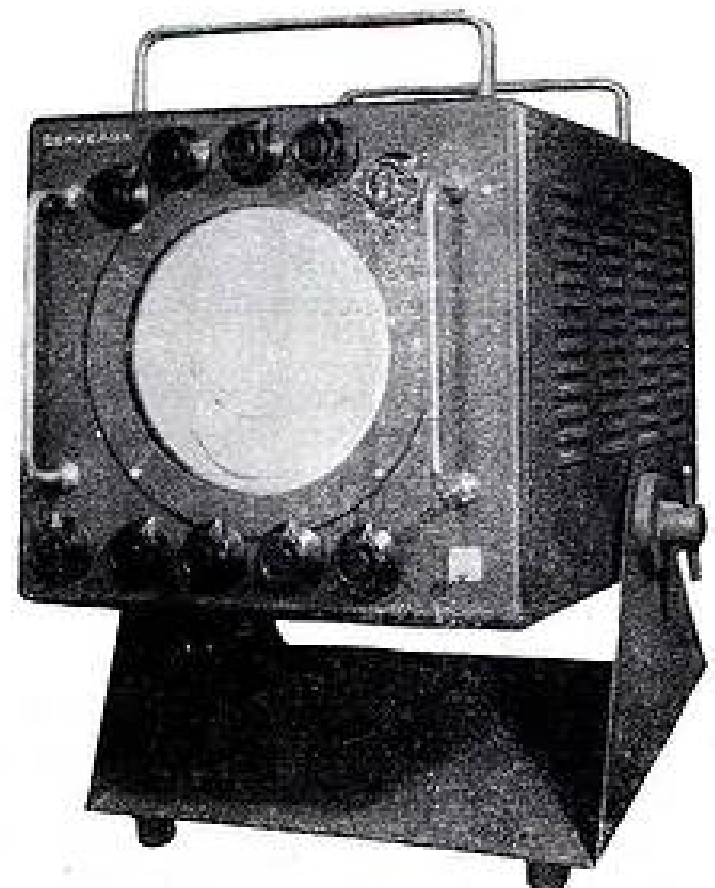
Récepteur d'image spirale à écran plat, rond et aluminé en modèle de table à inclinaison réglable. Les commandes de la camera se font à partir du récepteur.
