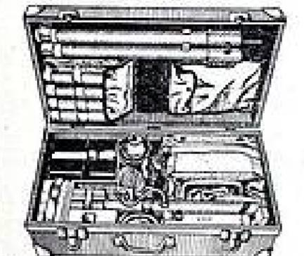
Permet de repérer les corps métalliques (trésors enterrés, etc., etc.). Fonctionne avec 2 piles de 45 V, 1 de 3 V et 1 de 6 V.
