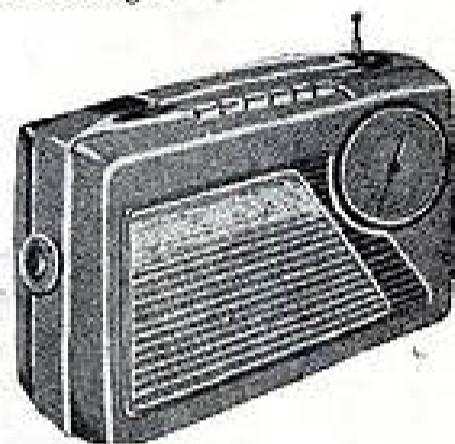
Le « Pygmy Golf », récepteur piles-secteurs, équipé de lampes de la série 90, à 6 gammes d'ondes, de 13,50 à 2.000 m. Commutation par clavier; position économique; (consommation HT: 7 mA) (Ets Pygmy-Radio)
