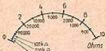
Fig. 10. — Echelle de lecture de l'ohmmètre 500 kΩ
