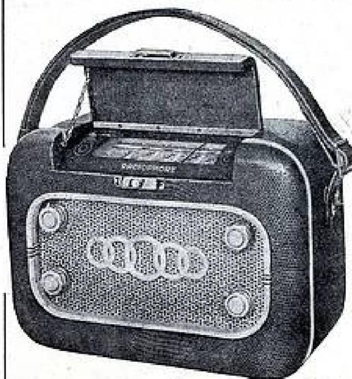
Poste piles - secteur, 4 gammes, 5 lampes, coffret gainé très élégant, antenne télescopique, l'ensemble complet, en pièces détachées, contenant les éléments de montage, y compris coffret, lampes et piles : **17.500**
