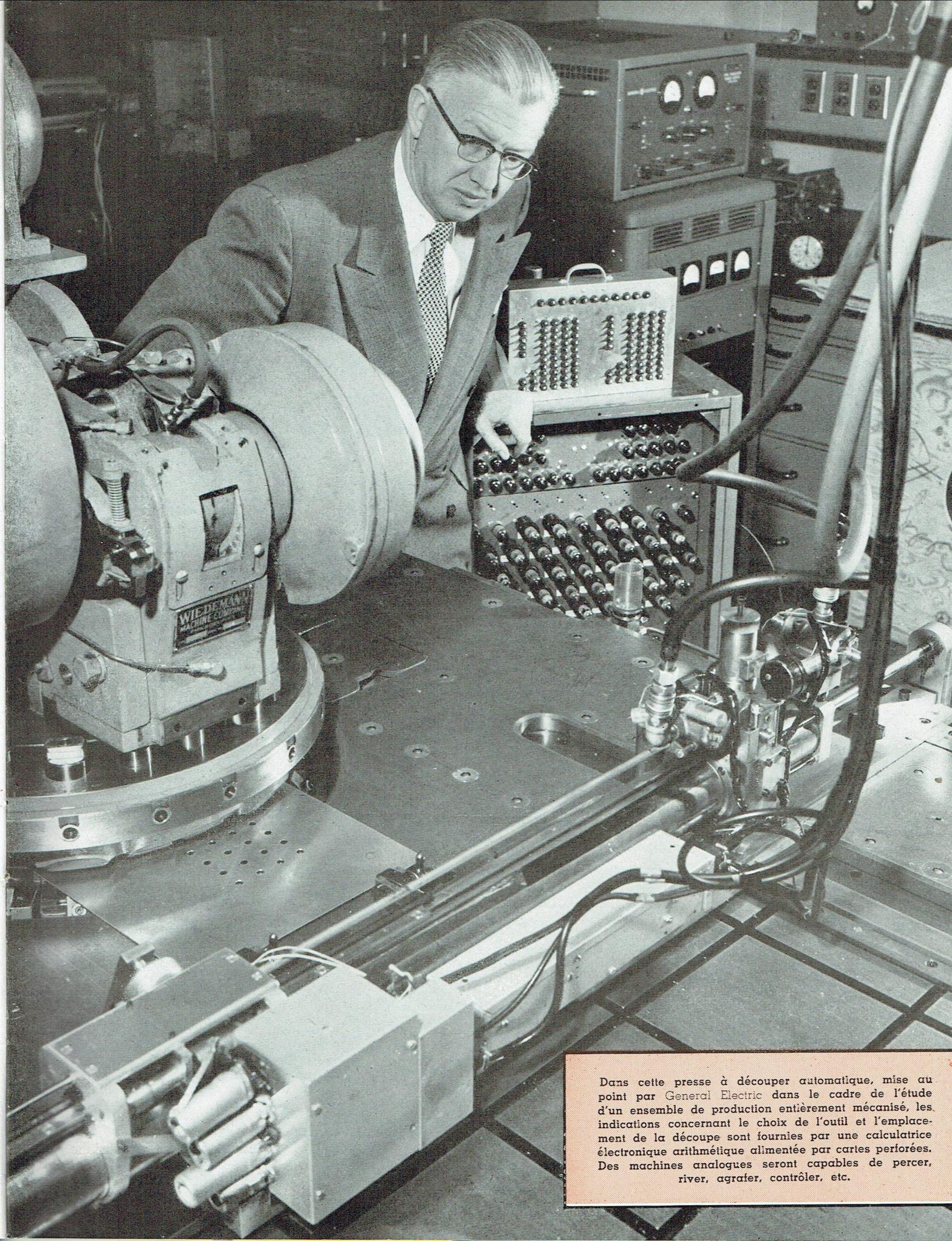
Dans cette presse à découper automatique, mise au point par General Electric dans le cadre de l'étude d'un ensemble de production entièrement mécanisé, les indications concernant le choix de l'outil et l'emplacement de la découpe sont fournies par une calculatrice électronique arithmétique alimentée par cartes perforées. Des machines analogues seront capables de percer, river, agraffer, contrôler, etc.
