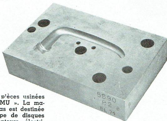
Quelques pièces usinées sur « USIMU ». La matrice du bas est destinée à la frappe de disques pour compteurs électriques.
