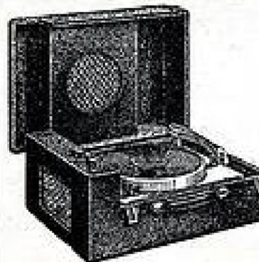
Partie ampli : 3 lampes « Rimlock » (EF41, EL41, GZ41). Puissance de sortie 3 watts. Haut-Parleur 17 cm ticonal « Audax » inversé, dans couvercle.
