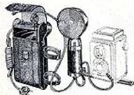
deux modèles de flashes décrits aujourd'hui. Lorsque l'on applique une différence de potentiel continue suffisante entre l'anode et la cathode, le gaz s'ionise, ce qui provoque l'éclair. Pratiquement, l'éclair est obtenu en déchargeant dans le tube un condensateur électrolytique chargé à une tension inférieure à la tension d'ionisation ou d'amorçage. On déclenche l'amorçage par
