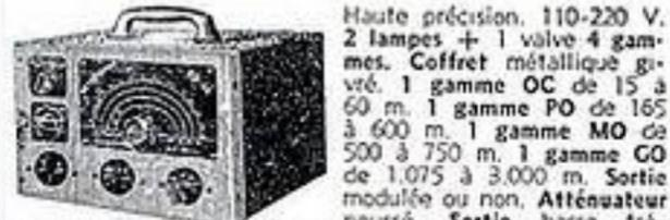
Haute précision. 110-220 V. 2 lampes + 1 valve 4 gammes. Coffret métallique giré. 1 gamme OC de 15 à 60 m. 1 gamme PO de 165 à 600 m. 1 gamme MO de 500 à 750 m. 1 gamme CO de 1.075 à 3.000 m. Sortie modulée ou non. Atténuateur poussé. Sortie basse fréquence 1.000 périodes. Cadran étalonné avec précision. Dimensions : 224x149x130 ..... **10.500**
