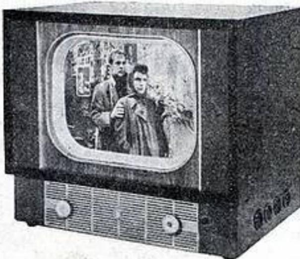
Téléviseur Philips TF 1435. — Téléviseur de table 310 lignes. Image 36 cm de diagonale, 17 lampes. Alimentation 110/127/220 V, alternatif 50 périodes. Consommation : 160 w a t t s. Dimensions : largeur 520, hauteur 455, profondeur 400 millimètres.
