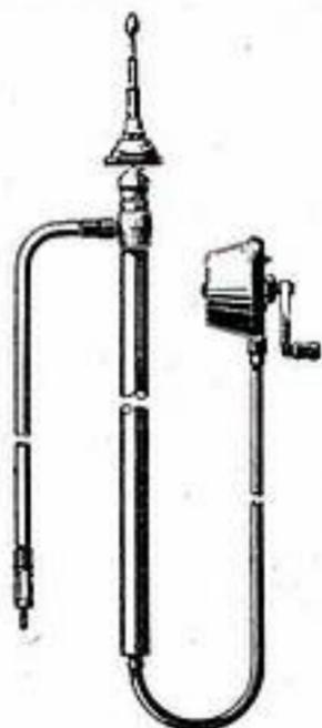
Fig. 1. — Antenne mécanique pour automobile, manœuvrée à l'aide d'une manivelle de l'intérieur de la voiture (Hirschmann).
