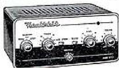
2 x 3 watts effectifs. 5 tubes multiples, tonalités grave et aiguë séparées. Balance, commutation mono/stéréo. Sélecteurs Radio, P.U., Aux. Sensibilités d'entrées : radio 100 mV, Aux. 150 mV, P.U. 50 mV. Impédance de sortie : 3 et 15  $\Omega$ . Courbe de réponse : de 40 cp/s à 18 Kc/s. Alimentation incorporée : 110/220 v, 50 cp/s, 100 w.
