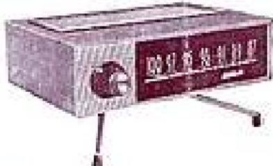
Permet la réception de la gamme. Modulation de fréquence dans la bande 87 à 118 MHz et les émissions en FM, système MULTIPLEX, 7 lampes (6BD6 - ECF82 - 2 x EF85 - EB91 - EM84 - EF80). Alimenté 110/240 V. Sensibilité : 1 μV - Bande passante : 200 kHz - Détection ultra-linéaire - Gain équilibré sur Multiplex. Niveaux BF constant permettant l'adaptation à tout appareil comportant une prise PU. (Le Tuner FM 62 peut être livré sans la platine MULTIPLEX, celle-ci étant amovible).
