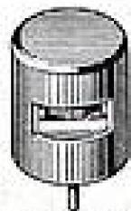
**Tête magnétique effacement type F :** Ferrocube, livré avec oscillateur Ferrocube, débit de la lampe 25 mA. Effacement total à 150 kHz, 1/2 piste haute ou basse sur demande. **6.300**
