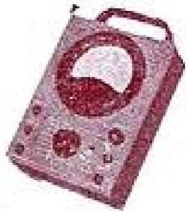
à 3 gammes étudié spécialement pour l'utilisation en Radio et Télévision, permet d'effectuer toutes les mesures de tension, intensité par la manœuvre d'un seul bouton. Échelle à lecture directe. Principaux avantages techniques :
