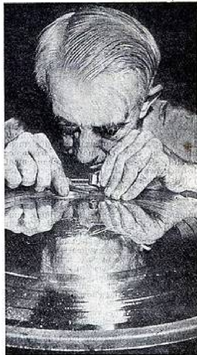
Un graveur de la firme Columbia s'assure qu'aucune poussière n'a provoqué la création de bulles au cours de l'opération de galvanoplastie qui intervient dans la fabrication des matrices sur lesquelles sont pressés les disques.
