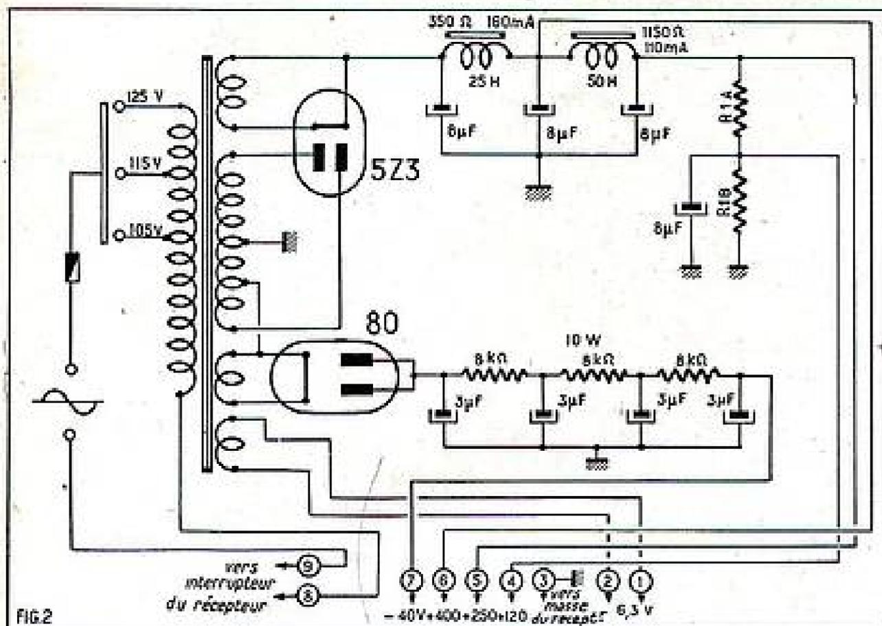
sont reliées directement à la masse et que ces tubes reçoivent leurs tensions de polarisation du bloc extérieur d'alimentation. La figure 2 donne le schéma officiel de ce dernier.
