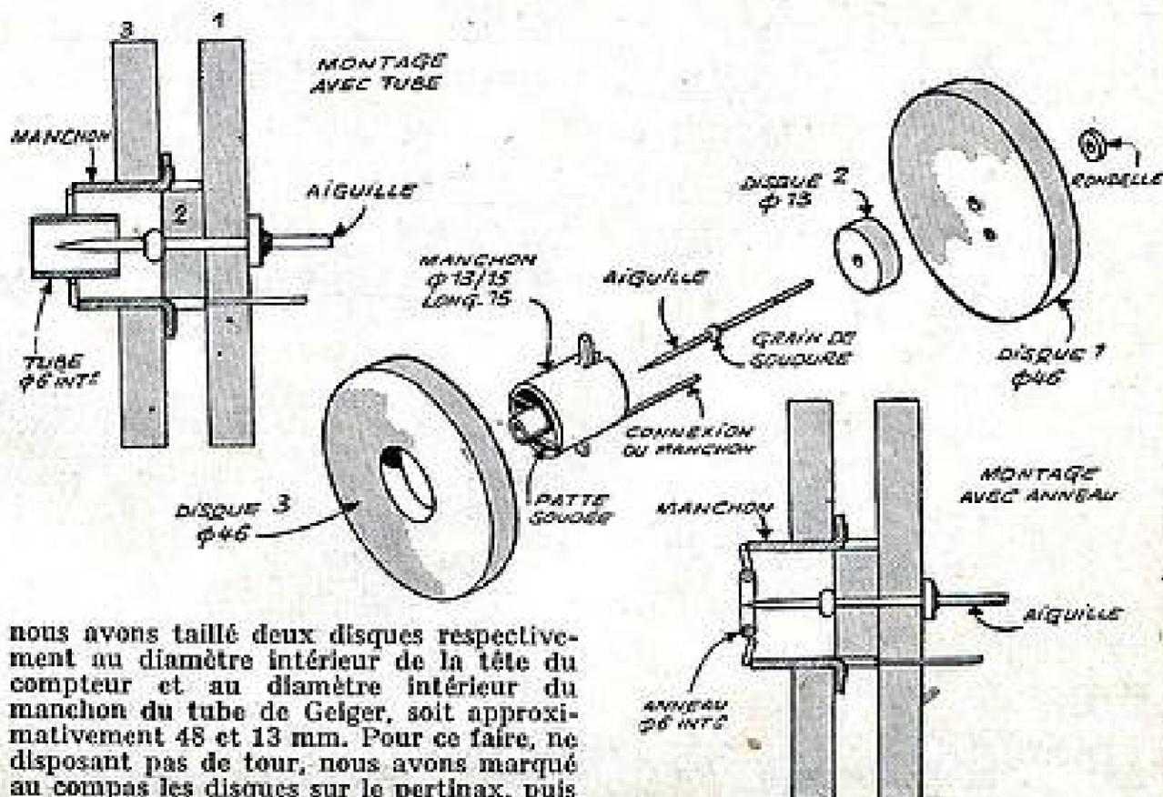
nous avons taillé deux disques respectivement au diamètre intérieur de la tête du compteur et au diamètre intérieur du manchon du tube de Geiger, soit approximativement 48 et 13 mm. Pour ce faire, ne disposant pas de tour, nous avons marqué au compas les disques sur le pertinax, puis
