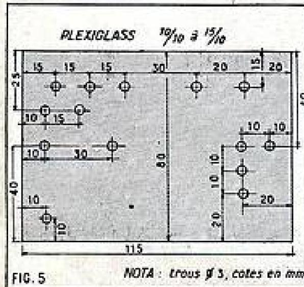
FIG. 5 NOTA : trous  $\phi$  3, cotés en mm.
