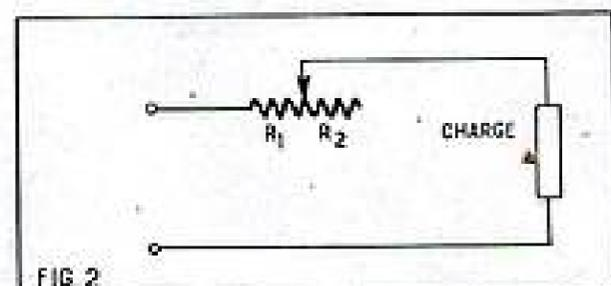
Dans les plus mauvaises conditions, c'est-à-dire pour une chute de 10-8=2 V, la portion de résistance du rhéostat serait malgré tout les deux tiers de la totalité puisque
