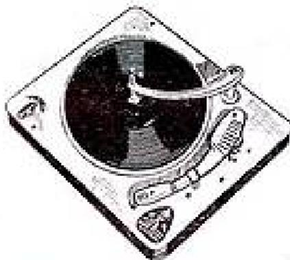
Changeur de disques 3 vitesses : 33 - 45 - 78 tours. Bras de pick-up avec tête cristal réversible, teinte ivoire ; fonctionne sur secteur alternatif 110 ou 230 volts 50 périodes. - Change automatiquement : 9 disques 25 cm ou 9 disques 30 cm ou 9 disques 17,5 cm. Dimensions : larg. 375 mm ; long. 315 mm ; haut. (maximum), 230 mm.
