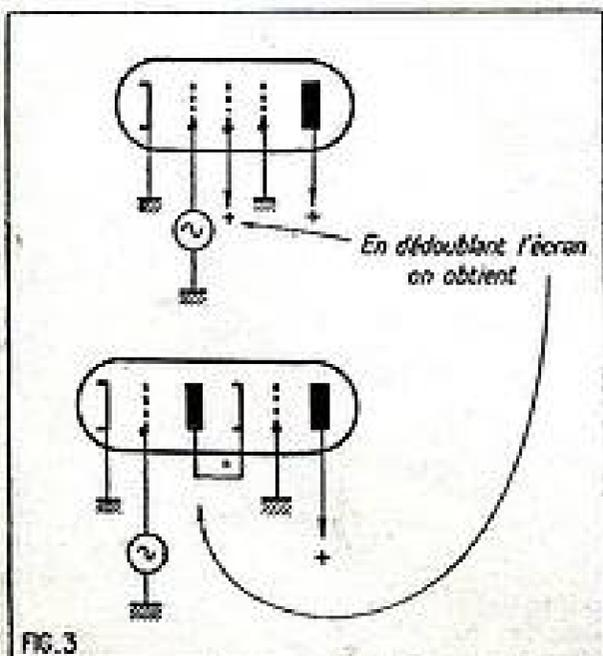
nettement séparés par un blindage intérieur ce qui réduit considérablement tout danger de réaction entre sortie et entrée. Ce blindage est réuni à la grille de la deuxième triode et la chose est normale, puisque cette grille travaille généralement à la masse.
