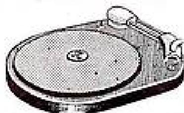
PLATINE trois vitesses : 33-45-78 tours. Moteur asynchrone 4 pôles 110/230 volts, 50 périodes, à régulateur de vitesse. Bras ultra-léger. Cellule de lecture piézo-électrique reversible équipée avec des porte-saphirs. Débrayage automatique de la rose d'entraînement à l'arrêt. Retour automatique du bras sur son support à la fin du disque. — Dimensions 340 x 280 x 135 mm. Partie sous la platine : 73 mm.
