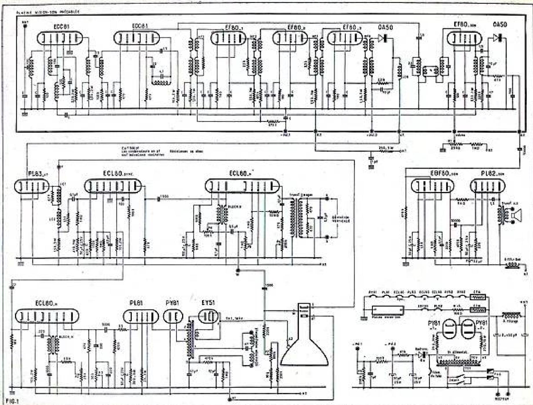
mando il y a une résistance de 220.000  $\Omega$ . La tension de relaxation image est aussi appliquée à cette grille de commande par un condensateur de 1.500 pF pour supprimer les retours de ligne.
