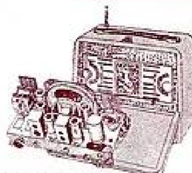
Récepteur portatif. Piles Super 5 lampes miniatures. Antenne télescopique escamotable.
