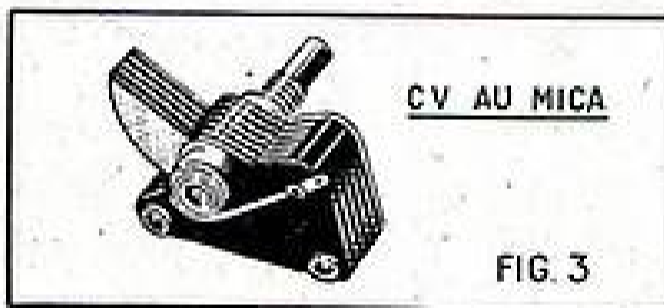
Fig. 3. — Aspect extérieur d'un condensateur variable à diélectrique.
