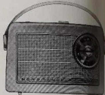
MAMBINO Um rádio de preço extraordinariamente económico. O "Mambino" é equipado com uma saída em duplo andar simétrico de grande eficiência e tem um maravilhoso som. 6 transistores e 2 diodos de germânio; saída em duplo andar simétrico de 1 Watt; antena Ferrit; ondas médias e longas; altifalante de concerto permanentemente dinâmico de 100 mm de diâmetro. Caixa de madeira. Dimensões: 220 x 140 x 83 mm. Peso: 18X gramas
