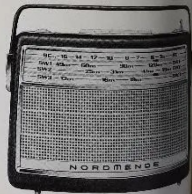
RUMBA E Com 3 bandas de onda curta 47,6 até 136 m, 21,4 até 50,9 m e 16,7 até 22,5 m - o NORDMENDE-Rumba é um aparelho especialmente desenvolvido para os apreciadores de ondas curtas. Possui uma excelente sensibilidade e selectividade, 3 transistores de germânio; transistor-Mesa; ondas médias e curtas; altifalante de 100 mm de diâmetro. Caixa de madeira. Dimensões: 230 x 165 x 70 mm. Peso: 1500 gramas
