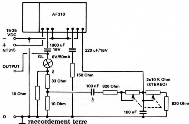
A l'aide de AF 310-3 et quelques éléments supplémentaires, on peut construire un bon générateur de son sans distorsion (distorsion 0,1%, tension de sortie de plus de 3 V, résistance interne plus petite que 10 Ohms).
